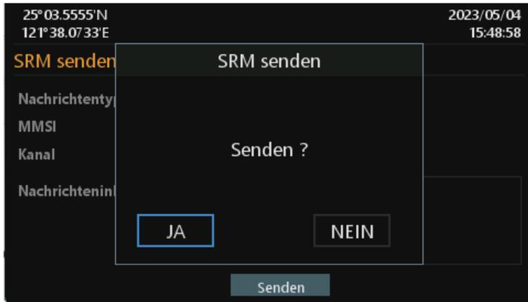
Um diese Seite zu verlassen, drücken Sie **Esc** und das System fragt, ob diese Ansicht verlassen werden soll. Wählen Sie **JA**, um die Ansicht zu verlassen, und **NEIN**, um in dieser Ansicht zu bleiben. Für eine einfache Verwendung drücken Sie **Esc** zweimal und das System kehrt zum Untermenü „Nachrichten“ zurück.
