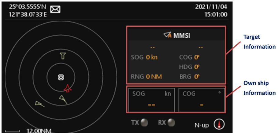
Die Radaransicht zeigt den Status des eigenen Schiffs und des Zielschiffs sowie deren Korrelationen an. Es handelt sich um eine proportionale Diagrammskala, die das aktuell angezeigte Verhältnis anzeigt. Der Abstand zwischen dem inneren und dem äußeren Kreis (1 Raster) ist die Zahl, die auf der Skala unten links angezeigt wird. Sie können den Maßstab anpassen, um Schiffe in unterschiedlichen Entfernungen anzuzeigen.
