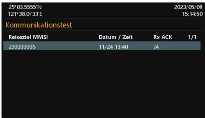
Drücken Sie **Fn** um den Kommunikationstest zu starten. Das System zeigt eine Zielliste an, die nur Ziele vom Typ Klasse A enthält. Wählen Sie mit den Richtungstasten ein Ziel aus und drücken Sie dann **↩** um die Übertragung der Nachricht 10 zu starten.
