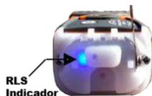
Cuando la radiobaliza está activada, si se vuelve a pulsar el botón **ON** (botón de encendido), el indicador luminoso emite mediante flashes la señal SOS en código Morse. Esto se puede utilizar para atraer la atención si hay poca luz. La señal SOS se repite cuatro veces cada vez que se pulsa el botón **ON**.
